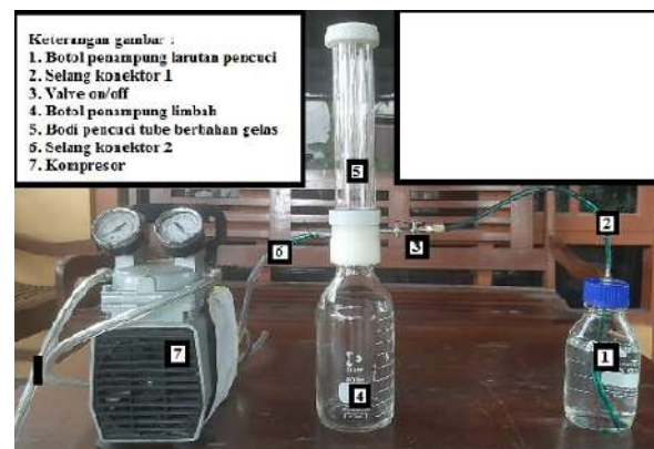
Gambar 4. Alat pencuci tube NMR dengan vakum
