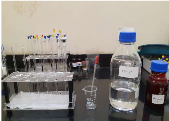
Gambar 2. Bahan dan alat yang digunakan pada metode pencucian tube NMR metode manual
